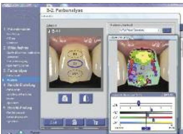
Farbanalyse und digitale Farbmessung mit dem Crystaleye
